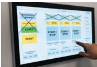
Die Visualisierung im Leitstand basiert auf einem modernen Touchpanel mit kapazitiver Multitouch-Technologie.
