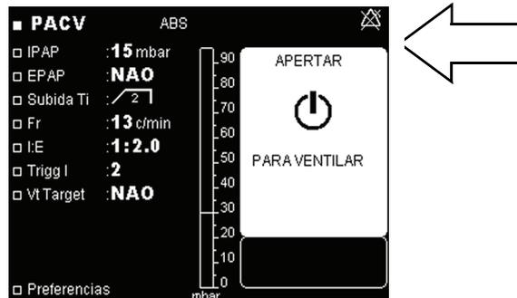
Figura 3-5. Colocar alarmes em pausa manualmente
