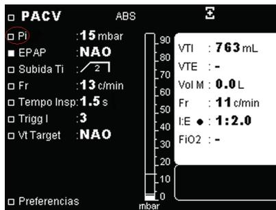
**Figura 1-9.** O menu no modo P A/C com a abreviatura Pi (configuração da Fuga)
