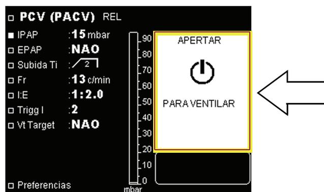
**Figura 5-7.** Caixa de diálogo para iniciar a ventilação
